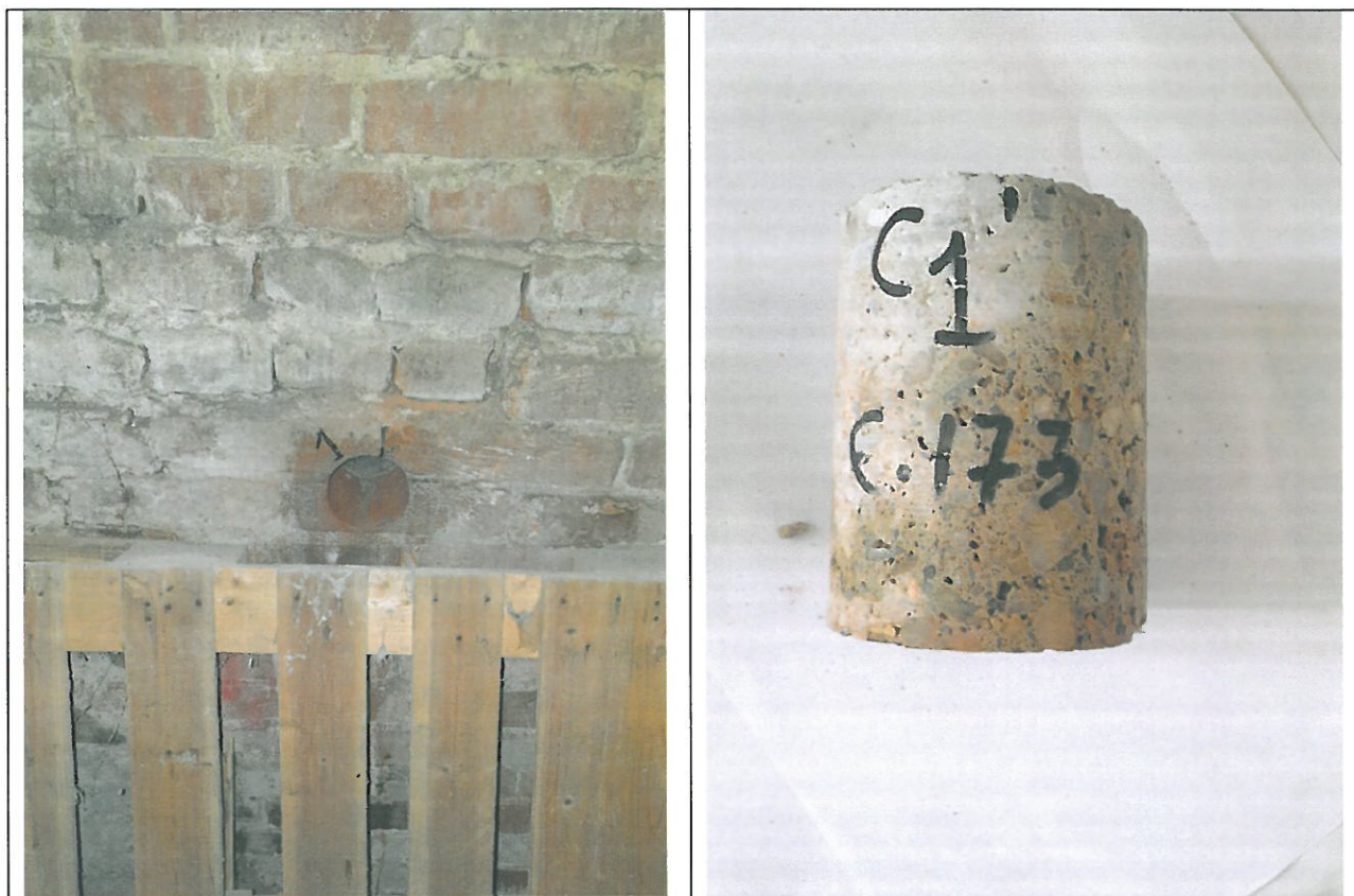
Zonă prelevare carota C 1 ' Element vertical Subsol (Carotă Beton)
